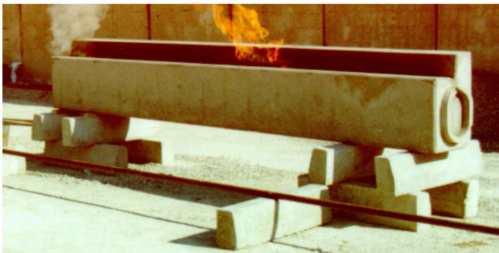
Obr. 3. Horenie v štrbine odvodňovacieho žľabu
