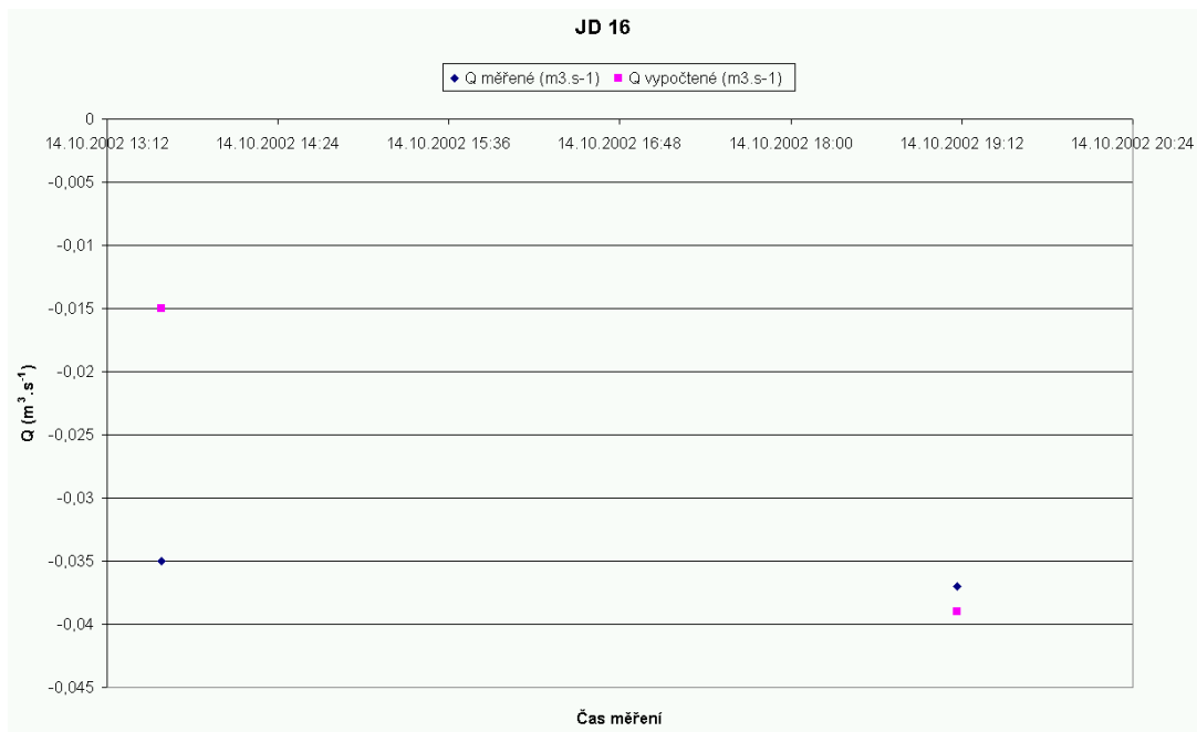
Obr. 5: Srovnání měřených a vypočtených hodnot na vrtnu JD 16, na ose x jsou hodnoty časů měření, na ose y jsou objemové průtoky plynu. V každém časovém okamžiku měření je uvedena hodnota měřeného (kosočtverce) a vypočteného (čtverce) množství proudícího plynu vrtem.
