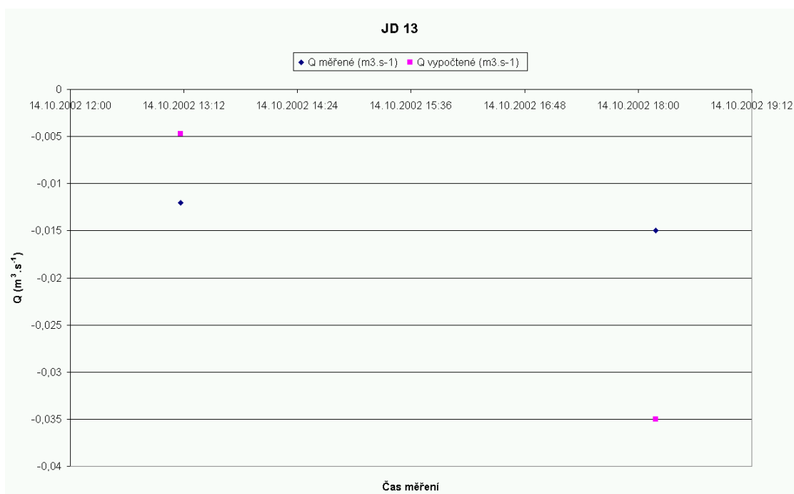
Obr. 4: Srovnání měřených a vypočtených hodnot na vrtu JD 13, na ose x jsou hodnoty časů měření, na ose y jsou objemové průtoky plynu. V každém časovém okamžiku měření je uvedena hodnota měřeného (kosočtverce) a vypočteného (čtverce) množství proudícího plynu vrtem.
