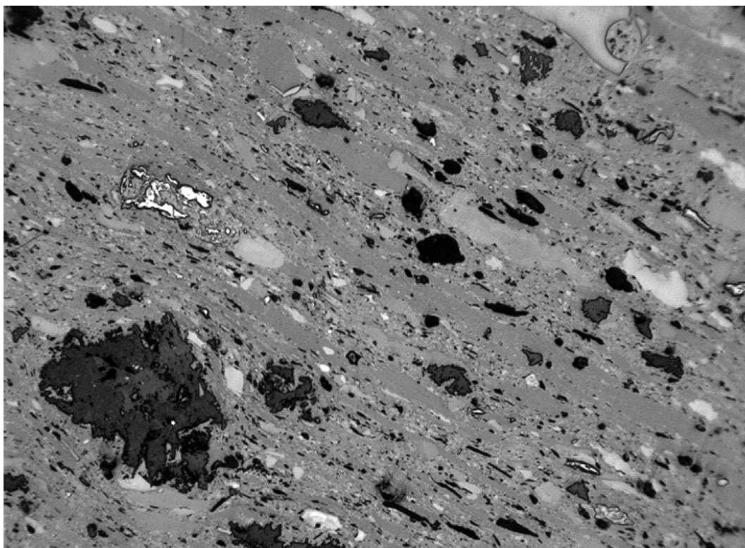
Obr. 2: Jemnozrná inertovitrinitická základní hmota s drobnými zrny anorganické příměsi. V základní hmotě jsou uložena zrna inertodetrinitu a větší zrna anorganické příměsi. Vrstevnatá struktura je jemně naznačena nevýraznými pásy vitrinitu - sloj 22b (086), dobývací prostor Staříč, zvětšení 400x, ol.im.
