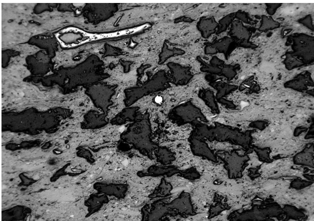
Obr. 5: Poloha s vysokým obsahem anorganických zrn - sloj 22a (079), dobývací prostor Staříč, zvětšení 400x, ol.im.
